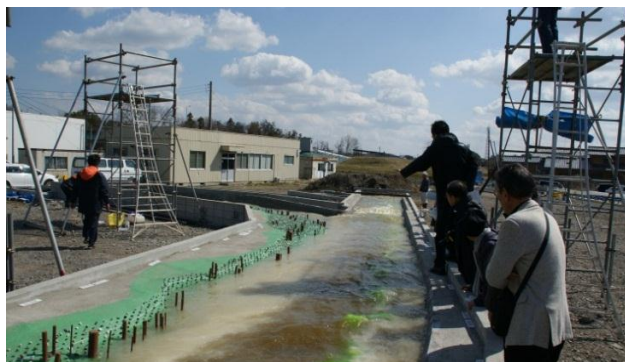
水理実験中の様子（左側の鉄棒が河畔林）
